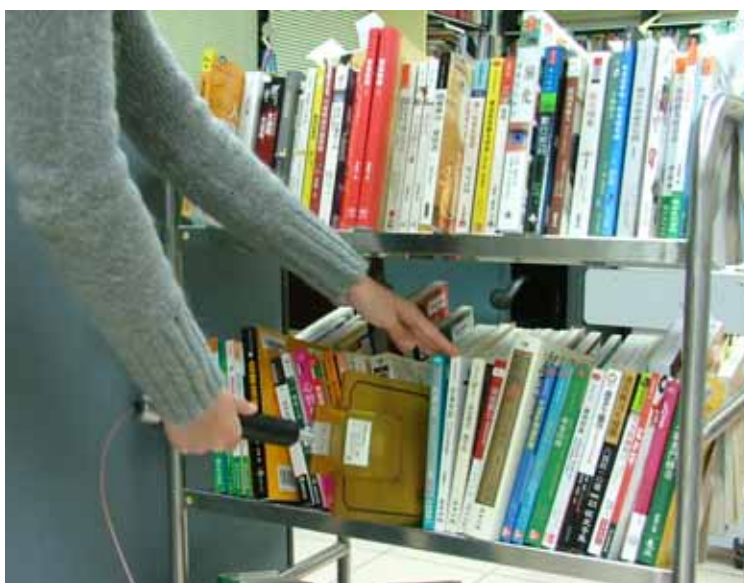
圖 7：RFID 盤點系統可以一次偵測到多本圖書，節省許多時間。
