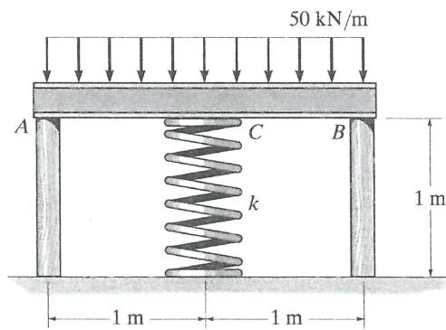
二、圖示結構材料之容許剪應力  $\tau_{\text{allow}} = 100 \text{ MPa}$ ，A、B 兩銷皆為雙剪銷(double shear)，試求其(a)A 點和 B 點所受的力(15 分)，(b)求 A 和 B 銷的最小直徑 (10 分)。
